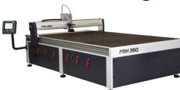
Modelo FRH350 TEX Área útil de trabajo de 300 x 200 cm y altura de 120mm
